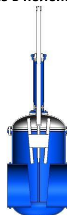
Разрез в положении «Открыто»
