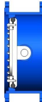
Разрез в положении «Закрыто» затворов для диаметров ≤1200
